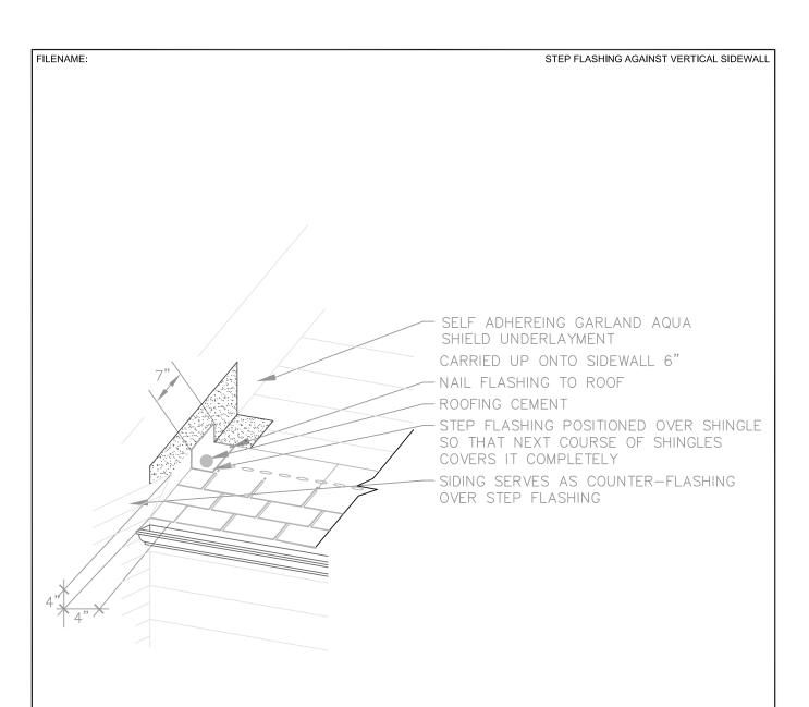
STEP FLASHING AGAINST VERTICAL SIDEWALL
